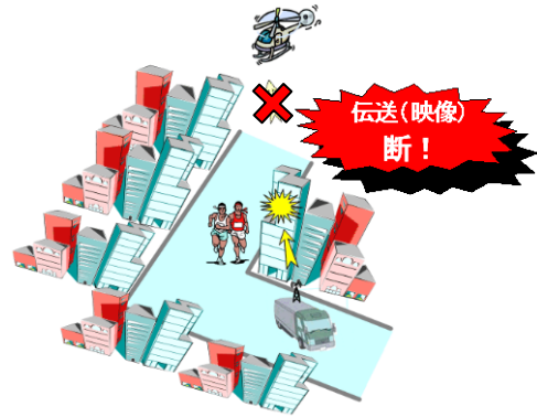
2GHz帯伝送における電波遮蔽の例2 (曲がり角などビル遮蔽による例)
