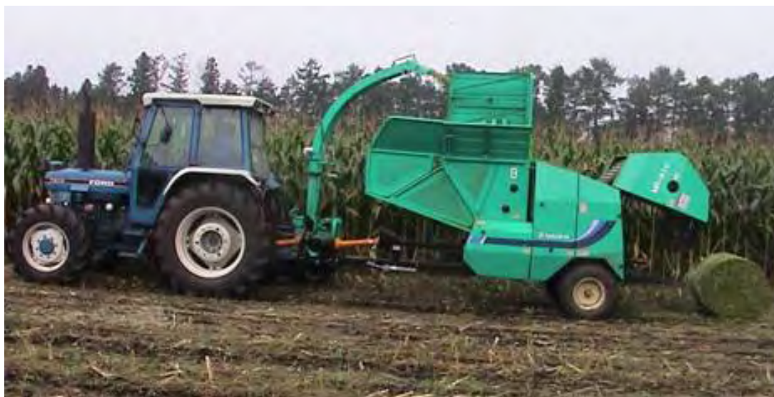
写真1 フォレージハーベスタ＋細断型ロールベアラによる収穫作業
