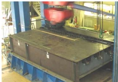
鋼床版試験体の輪荷重走行試験
