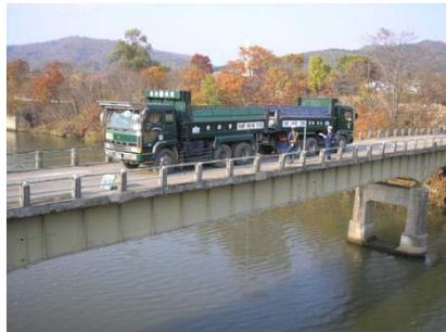
撤去予定橋梁を用いた現地載荷試験
