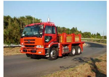
舗装走行実験場を使った舗装の耐久性能評価
