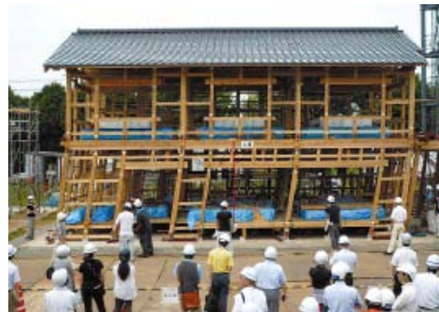
伝統的木造住宅の実大構造加力実験 (成果は建築基準法の技術基準に反映)
