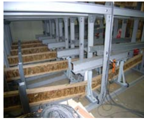
木質複合梁の強度試験の様子
