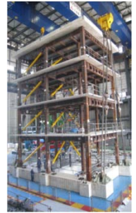
鉄骨構造躯体の振動台実験の様子
