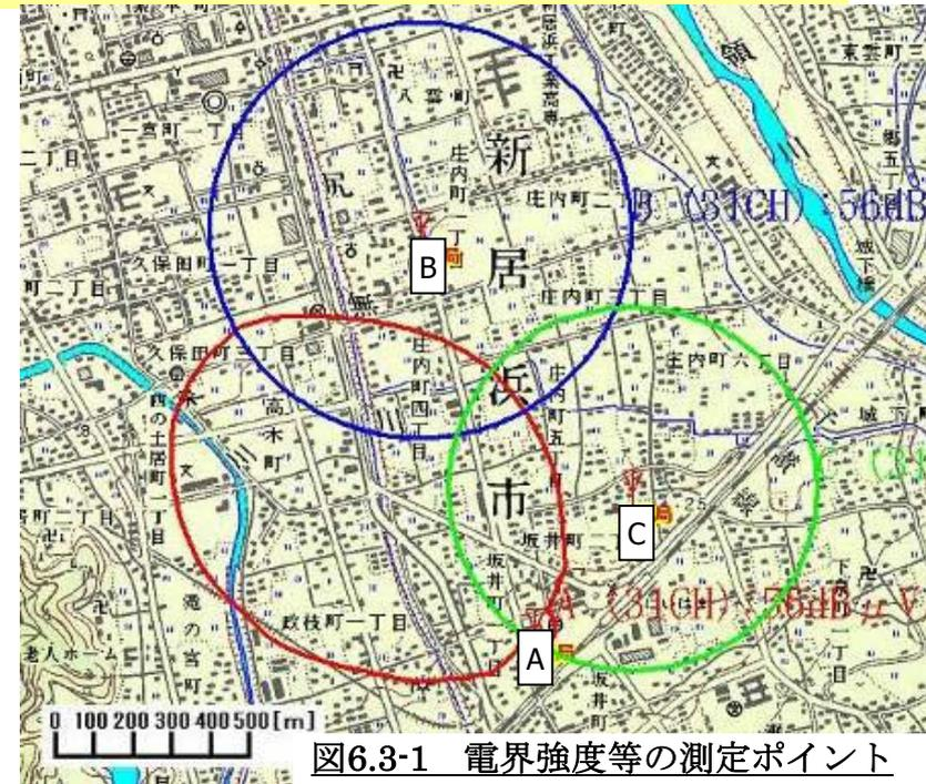
送信アンテナを20m(3階屋上)と8m(自営柱)に設置
