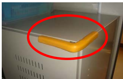
教室内での児童の安全に配慮し、充電保管庫の突起部をラバー保護
