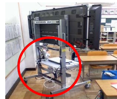
教室前方での可動を考慮し、機器配線を整理
