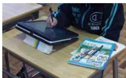
タブレット PC と机の間に物を挟んで蛍光灯が画面に反射することに対応した例
