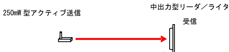
参図 7-4 920MHz 帯 250mW 型アクティブ系小電力システムと中出力型 920MHz 帯パッシブタグリーダ／ライタの干渉モデル
