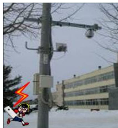
図 1-5 950MHz 帯アクティブ系小電力無線システムの利用例(子供見守りシステム)
