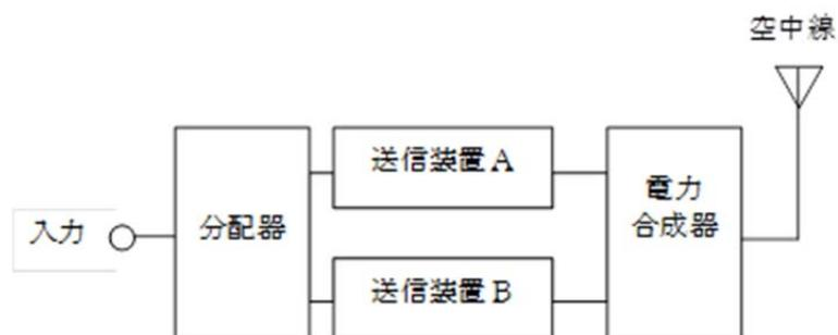
第10図に示す構成例では、各々異なる周波数の送信のための $n$ 系統の現用送信装置に対し、1つの予備送信装置を配置する。任意の現用送信装置が故障した場合、予備送信装置に故障した系統の信号を入力して、目的とする送信周波数を設定することで、現用送信装置の機能を代替する。
