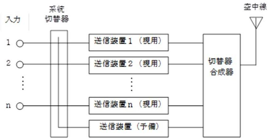
(オ) 地球局設備について、副局（伝送路符号化装置、送信装置及び空中線）を設置する措置（第11図参照）
