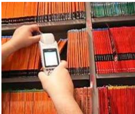
図 1-4 中出力型 950MHz 帯パッシブタグシステムの利用例（図書の棚卸し）
