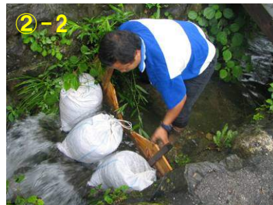
堰による流量計測
