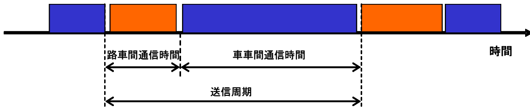
図 2.2.2-1 車車間通信と路車間通信の共用運用の一例
