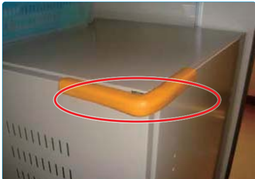
充電保管庫の突起部に緩衝材を貼り付けた例
