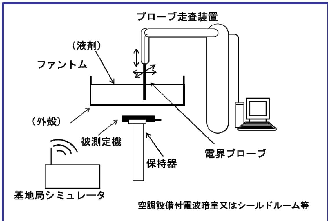
図 4.1 測定系の基本構成図
