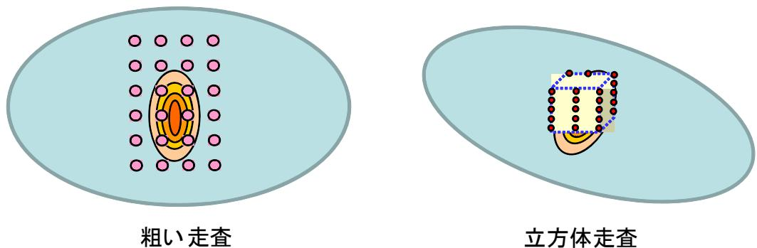
図 6.4 SAR 測定の概念図
