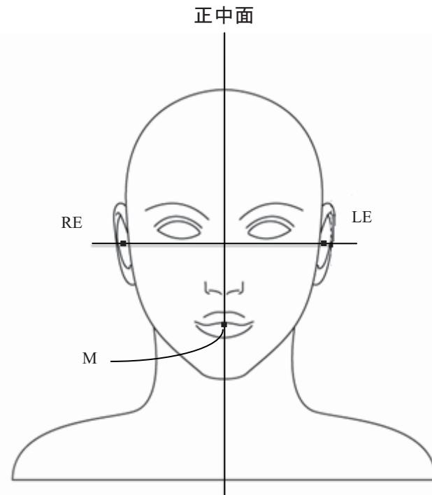
図 5.3 被測定機の位置決めの基準点
