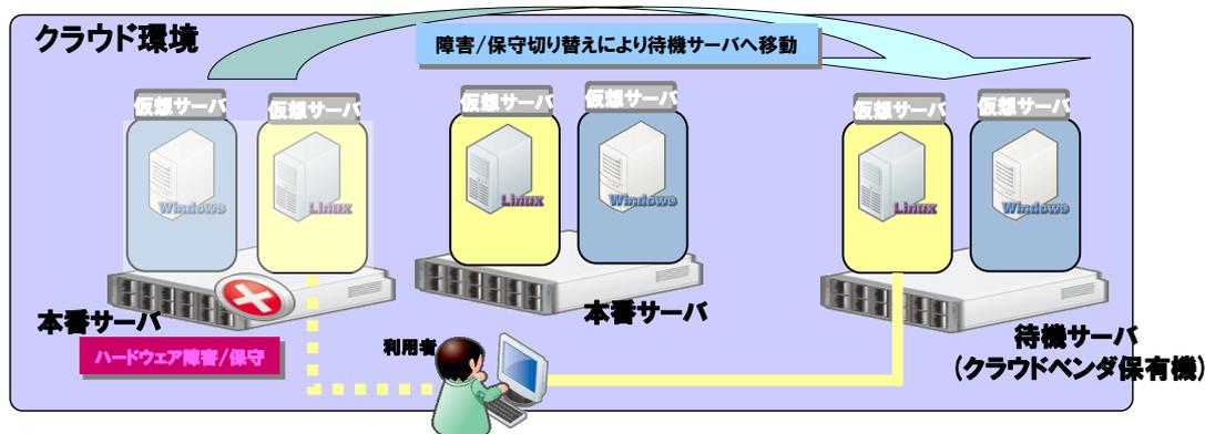
図 6-1 障害切替の概要
