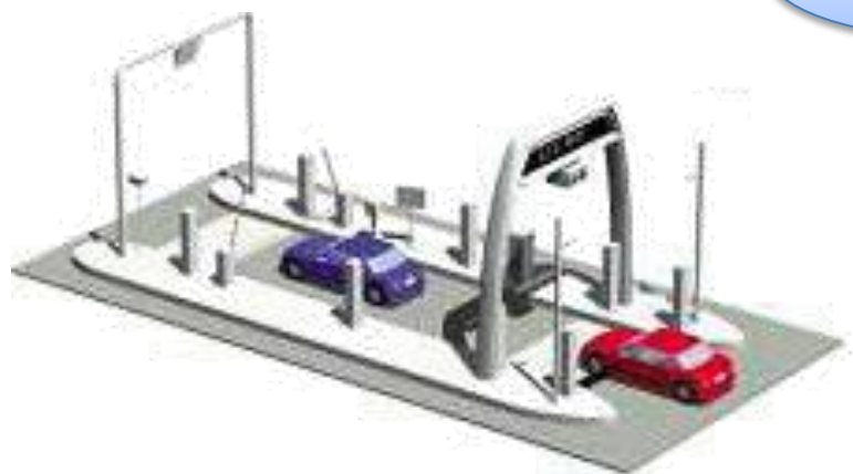
有料道路自動料金支払システム（ETC）
