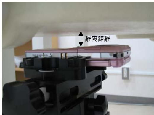
図 6.1 測定対象無線機器の設置例
