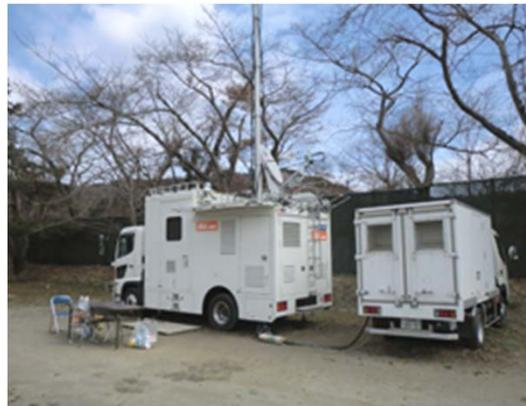
車載型基地局 (左) と移動電源車(右)
