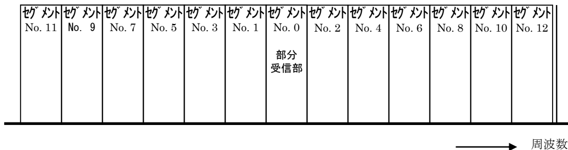
図 2.4-33 伝送スペクトル上の OFDM セグメント No（フルセグ型）
