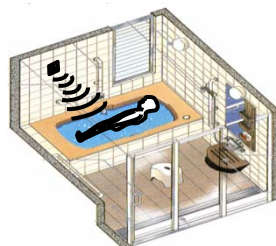
(2) 浴室内人体異常検出
