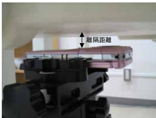
図 6.1 測定対象無線機器の設置例
