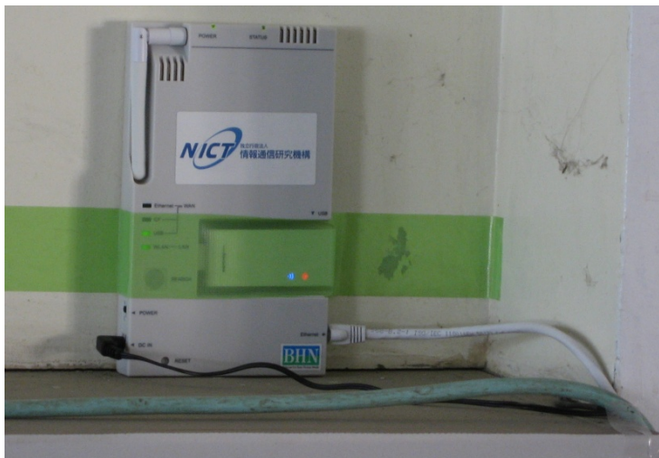
インターネット接続に用いたコグニティブ無線ルータ
