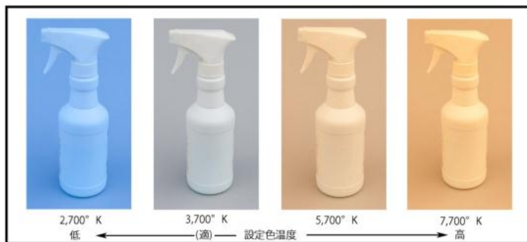
図 16 照明色温度 3,700° K のとき、図中の各色温度設定で撮影した際の画像
