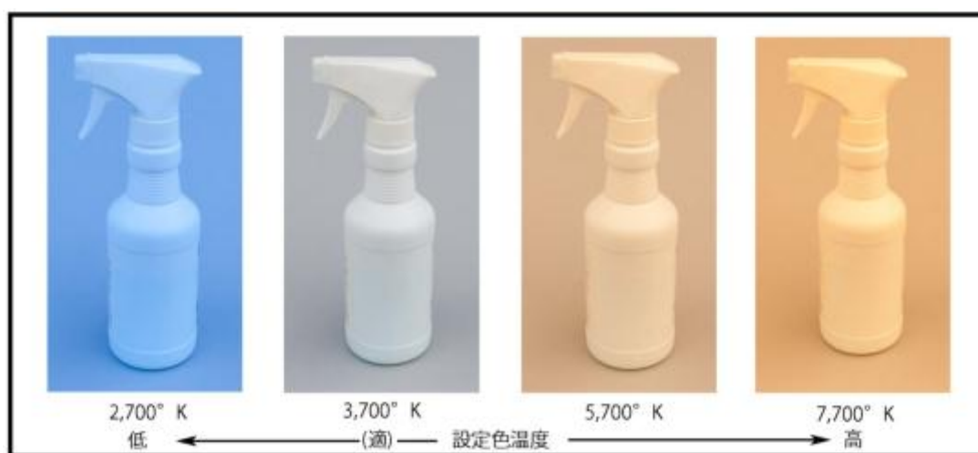
図 16 照明色温度 3,700^{\circ}\text{K} のとき、図中の各色温度設定で撮影した際の画像
