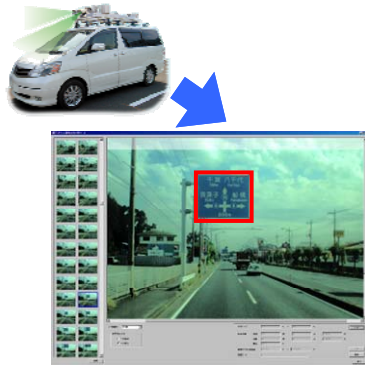
図4 移動車両による広告看板の計測
