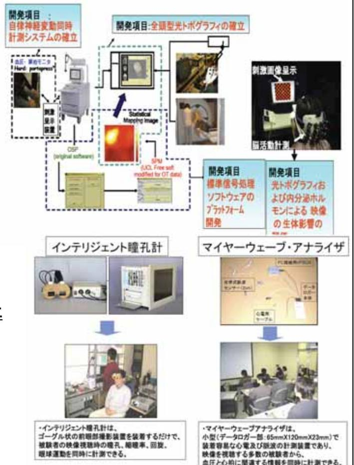
・インテリジェント瞳孔計は、ゴーグル状の前眼部撮影装置を装着するだけで、被験者の映像視聴時の瞳孔、縮瞳率、回旋、眼球運動を同時に計測できる。
