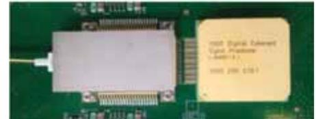
図6: デジタルコヒーレント信号処理回路
