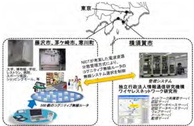
ヘテロジニアス型コグニティブ無線評価実験の構成図
