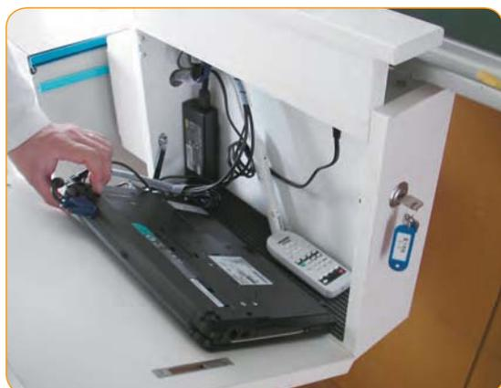
折りたたみ式の収納箱にインタラクティブ・ホワイト・ボード用PCを格納した例
