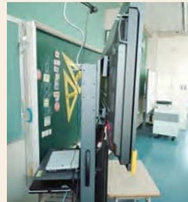
児童に背を向けずにPCを操作するためPCをインタラクティブ・ホワイト・ボードの背面に設置できるようにした例
