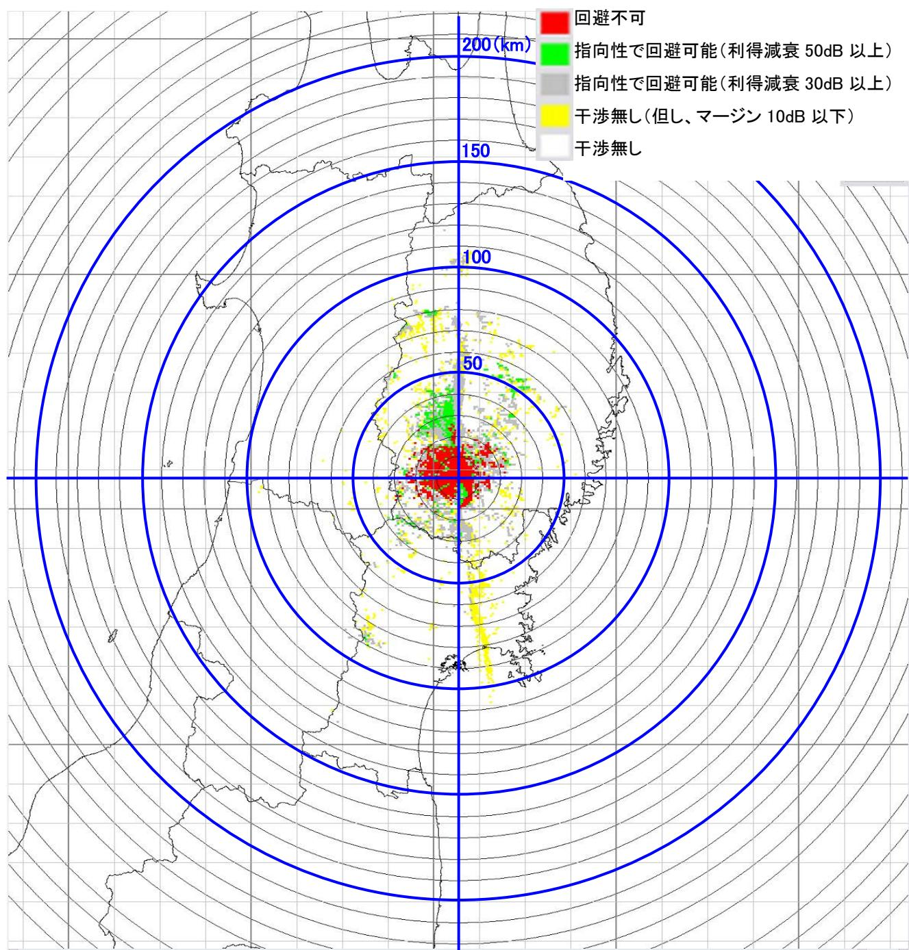
5-② 水沢 10m 電界強度マップ… $\phi$  30cm パラボラアンテナ送信機
