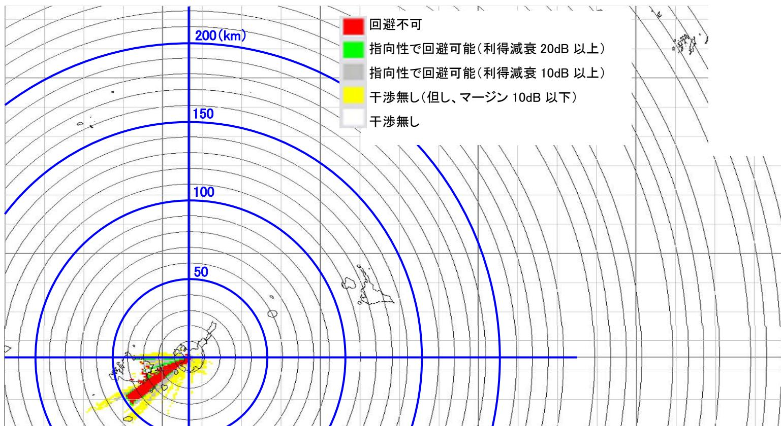
5-① 水沢 10m 電界強度マップ… $\phi$  60cm パラボラアンテナ送信機
