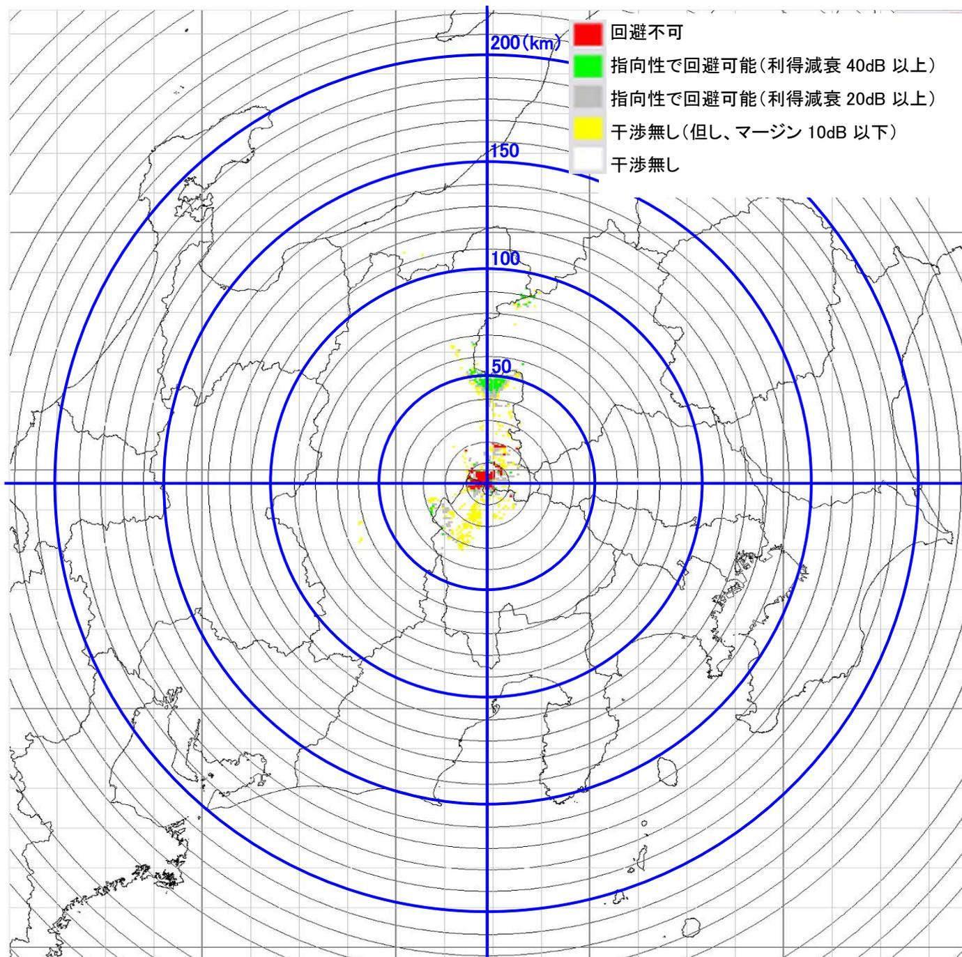
11-④ 野辺山(NRO) 電界強度マップ…高利得 90 度セクターアンテナ送信機
