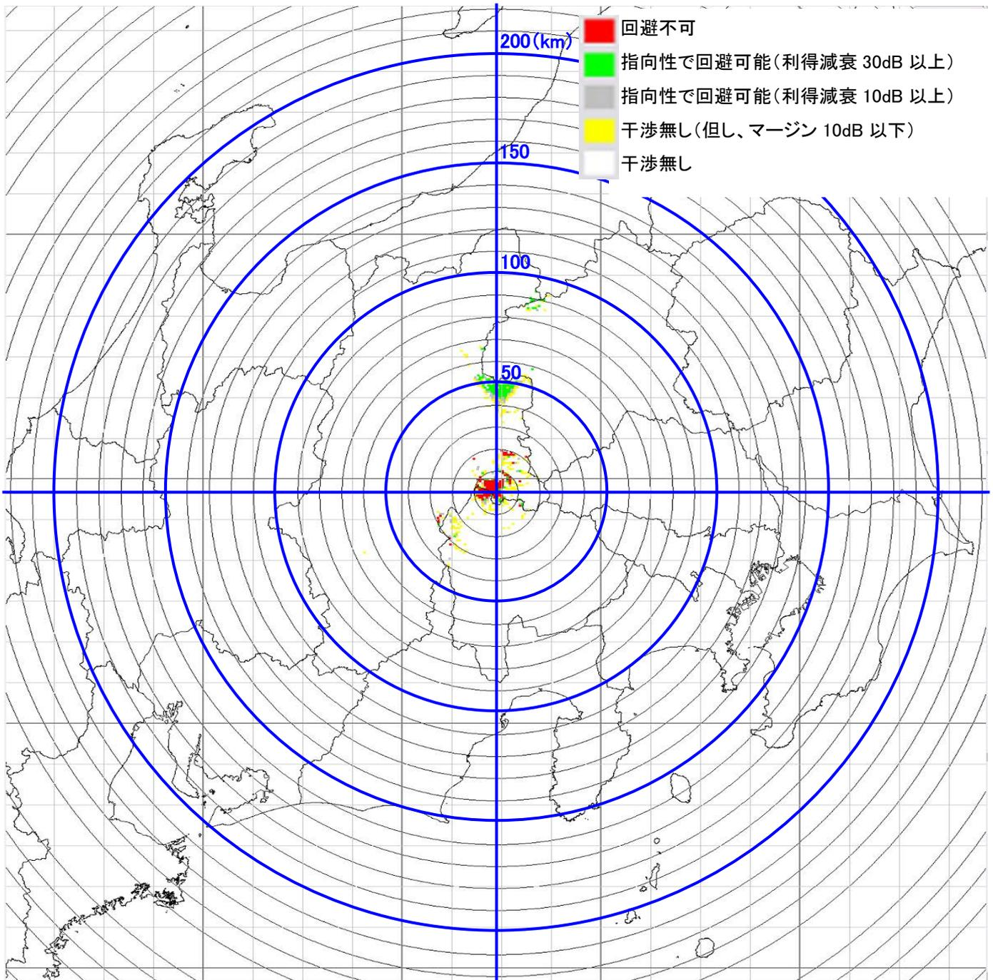
11-⑤ 野辺山(NRO) 電界強度マップ…90度セクターアンテナ送信機
