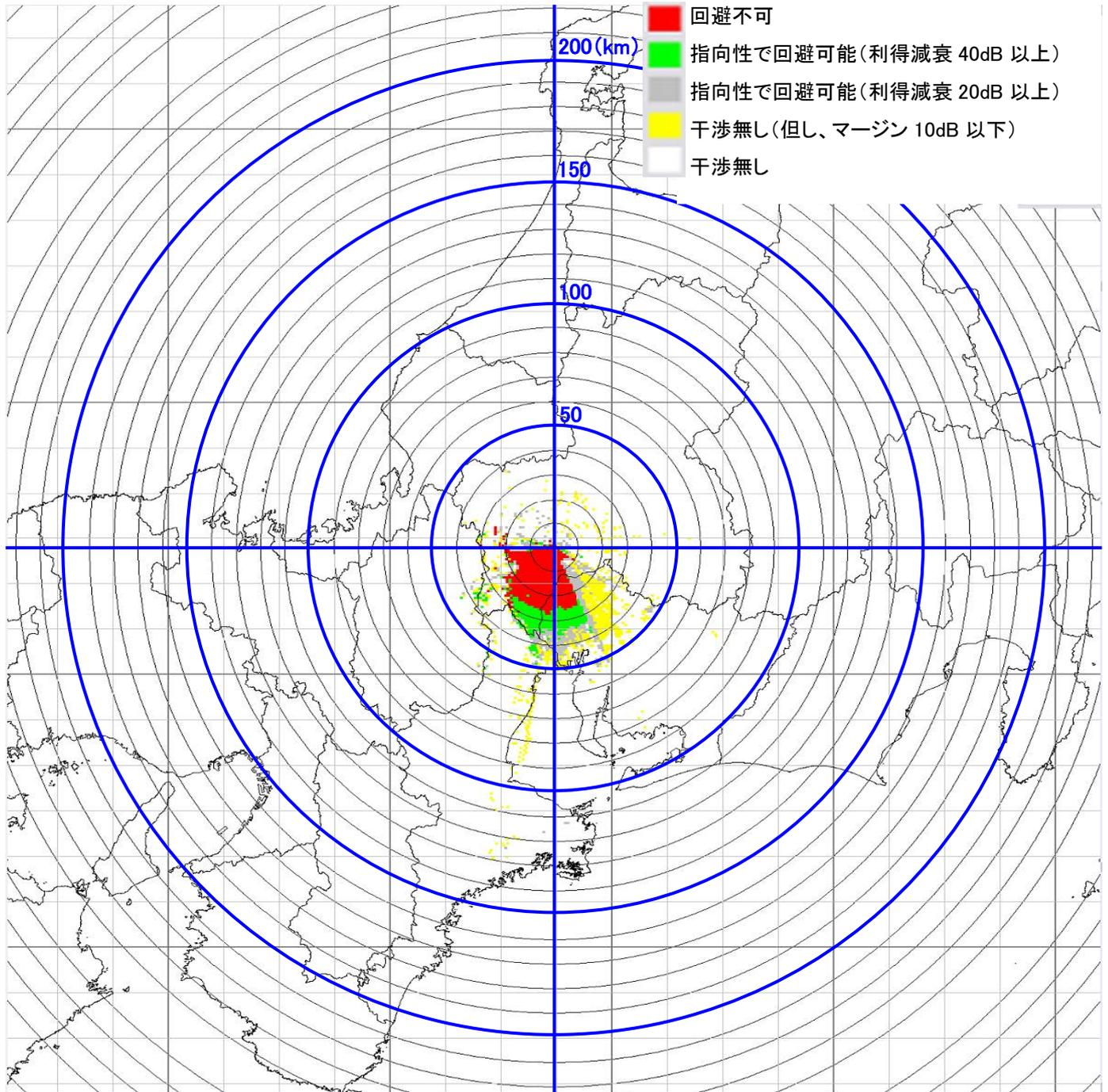
13-④ 岐阜大岐阜 電界強度マップ…高利得 90 度セクターアンテナ送信機
