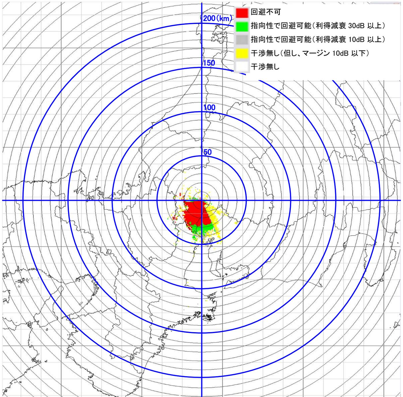
13-⑤ 岐阜大岐阜 電界強度マップ…90度セクターアンテナ送信機
