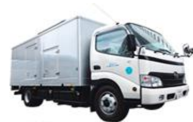
非常用電源車
