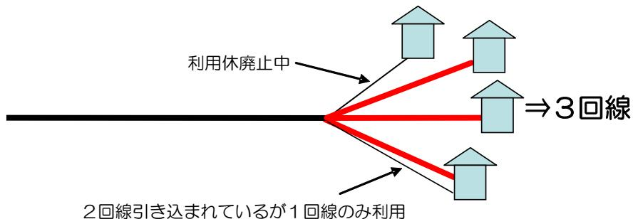
例4) それぞれの建物まで引き込まれた3回線が、それぞれ①放送のみ、②放送+インターネット、③放送+インターネット+IP電話のために用いられている場合のうち、それぞれの建物まで引き込まれた固定端末系伝送路設備を、当該放送を行う一般放送事業者が設置している場合
