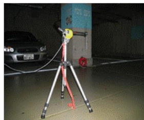
受信アンテナ(八木アンテナ)と 地上デジタルテレビジョン放送アナライザ
