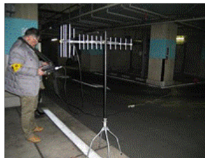
受信アンテナ(八木アンテナ)と 地上デジタルテレビジョン放送アナライザ
