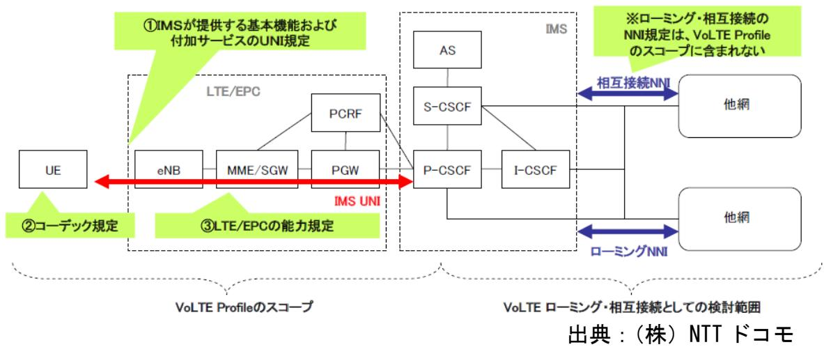
図 1.1.2-2 VoLTE の設備構成及び VoLTE Profile のスコープ等
