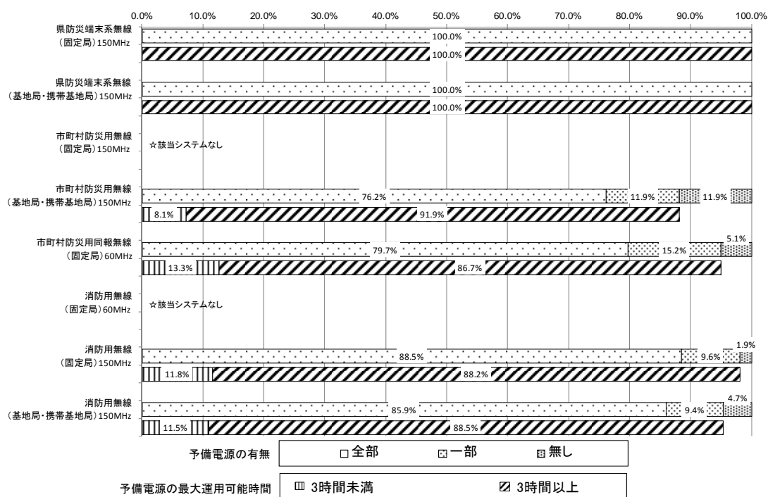
図表－８－４－１５ 予備電源保有状況及び予備電源の最大運用可能時間 (県防災端末系無線・市町村防災用無線・消防用無線)(内訳)【中国】
