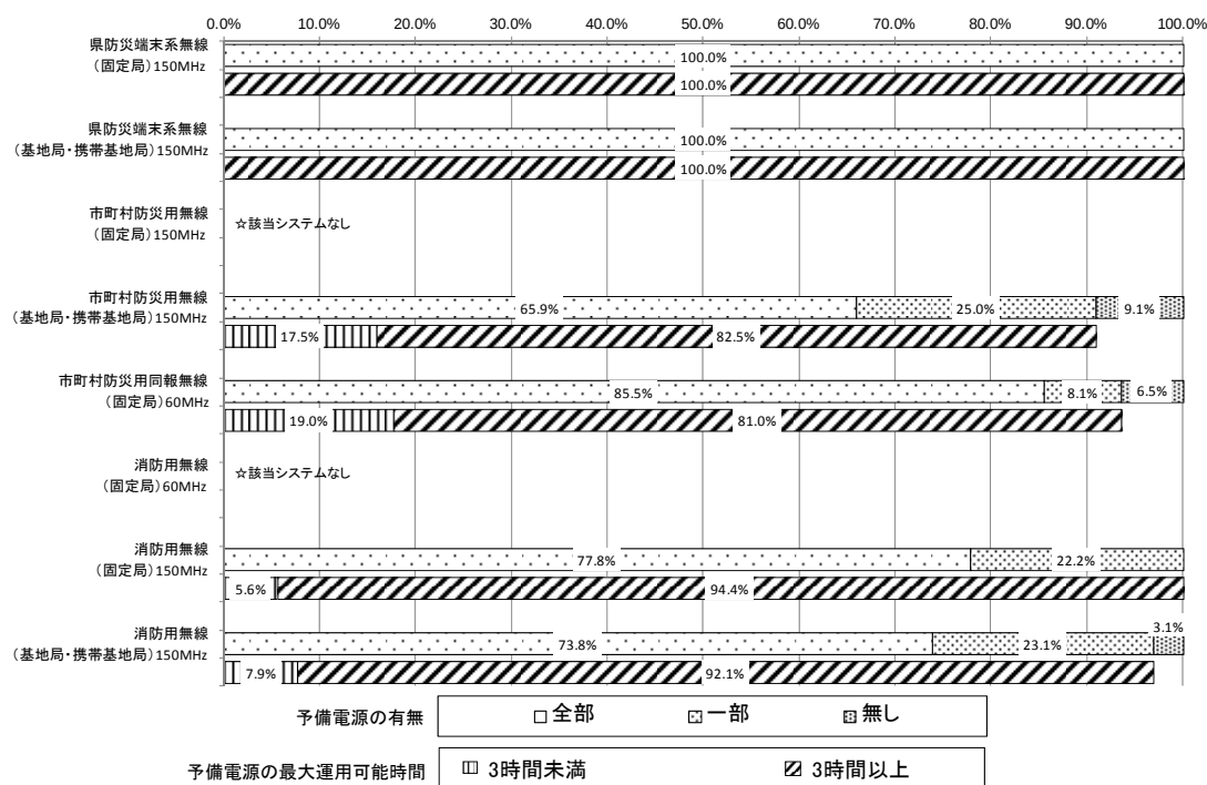
図表－９－４－２０ 予備電源保有状況及び予備電源の最大運用可能時間 (県防災端末系無線・市町村防災用無線・消防用無線)(内訳)【四国】
