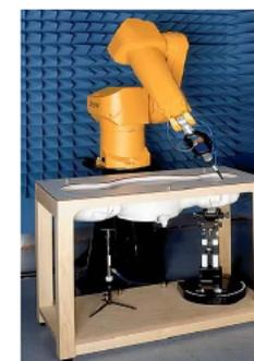
電波吸収率測定システムの開発
