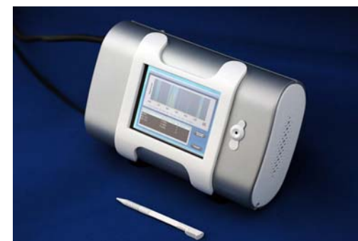
開発したソフトウェア無線技術を利用したコグニティブ無線機
