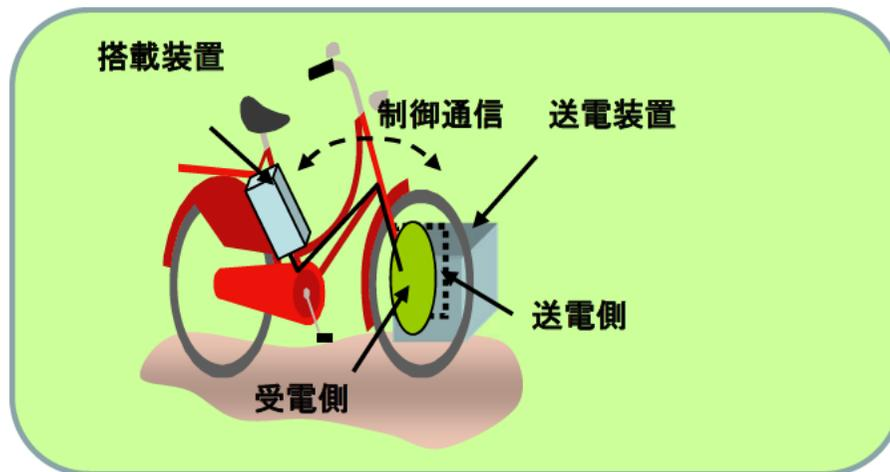
電動カート、電動車椅子のワイヤレス充電の例
