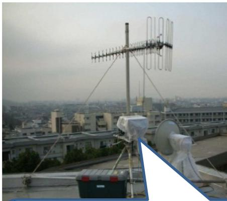
仮設で固定し、放送局又は受信基地局に素材伝送する場合に使用され、伝送距離は50kmにも及ぶ場合がある。(モデル1)
