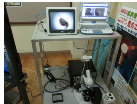
遠隔顕微鏡の本校側の構成。 分教室から要望を受け、プレパラートや 対物レンズの倍率変更等の操作を行う
