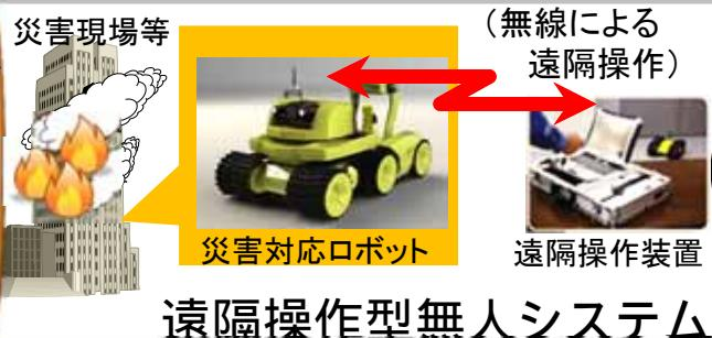
災害現場など人の立入りが困難な場所等において、無線による遠隔操作により、安全・効率的に作業を行うシステム
