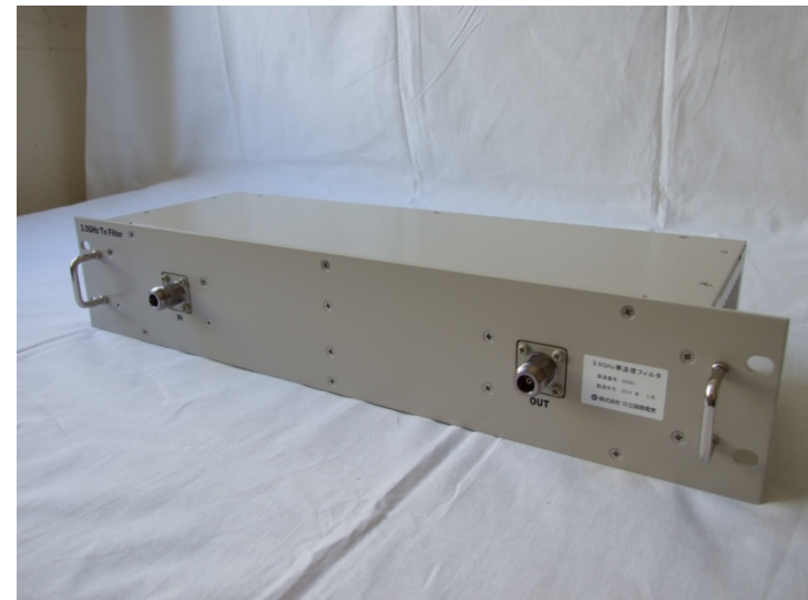
図5 送信フィルタの概観 (H88.1mm x W482.6mm x D142.0mm, 3.6kg)
