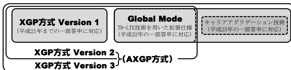
図表 3-18 XGP方式/AXGP方式の構成イメージ
