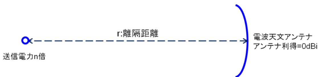
自由空間伝搬では、シングルエントリーの離隔距離  $r_s$  に対してアグリゲートの離隔距離  $r_a$  は  $\sqrt{n}$  倍になる。
