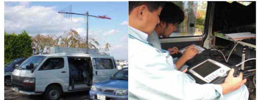
電波測定車及び測定作業
