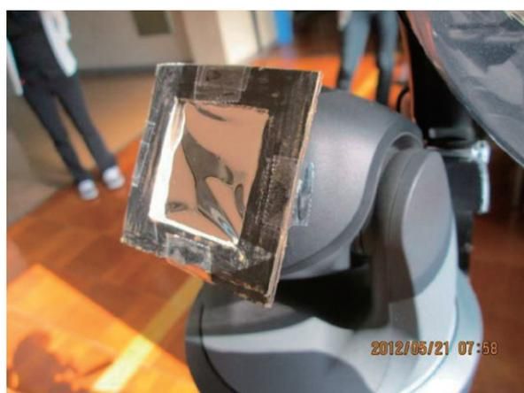
日食観測に使用した、減光フィルタを取り付けたリモートカメラの例
