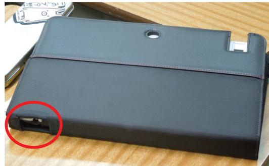
電源プラグを抜き差しできるように、タブレットPCのカバーに穴を開けた例
