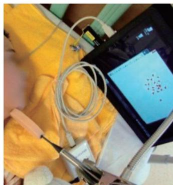
レバー式スイッチで操作している例
