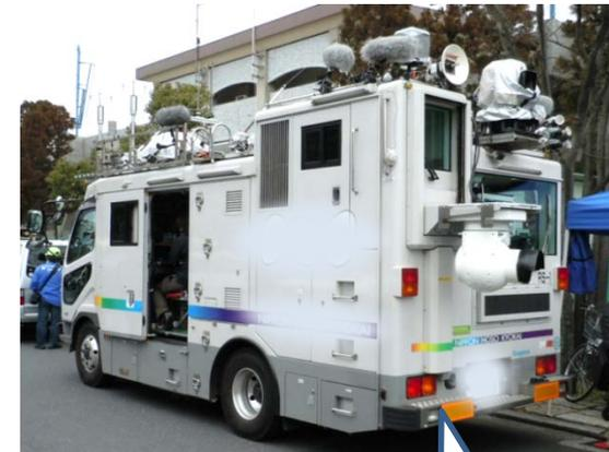
ゴルフ中継や緊急報道などで中継車等へ素材伝送する場合に使用され、伝送距離は数百mから1kmの間で使用される。(モデル5)
