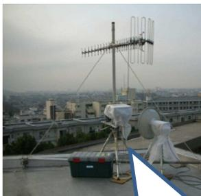
仮設で固定し、放送局又は受信基地局に素材伝送する場合に使用され、伝送距離は50kmにも及ぶ場合がある。(モデル1)
