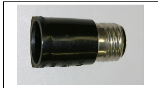
原因となった照明点滅用アタッチメント
